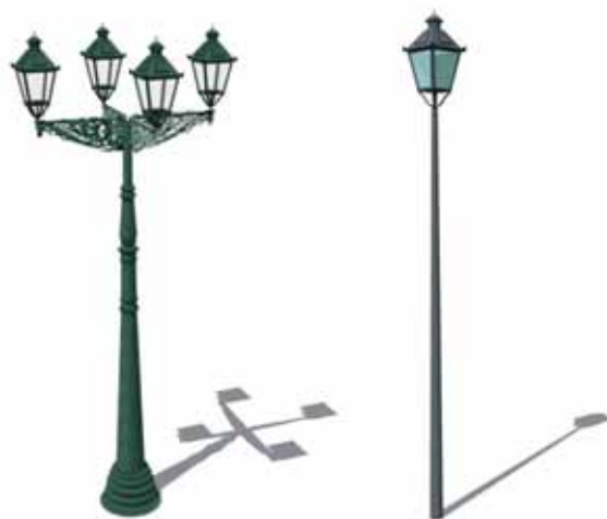
obr. 11: návrh repliky štvorramenného kandelábra a náznakovej rekonštrukcie stojanového svietidla s lucernou zdroj: [7]
