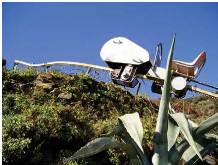
obr. 1. Zubačková jednokoľajná trať na prepravu nákladov v neprejazdnom reliéfe Národného parku Cinque Terre v Taliansku – účinné technické riešenie šetrné k chránenému prostrediu.
